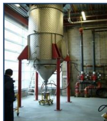
16 Сурет – Plasma Atomization технологиясы: а – плазмалық атомдау процесінің сұлбасы; б –Raymor атомайзері [15]
