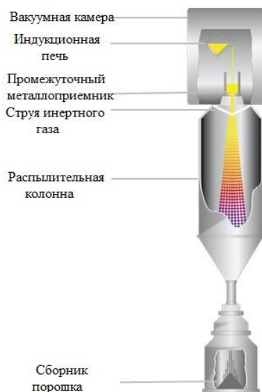
8 Сурет – Вакуумдық-индукциялық балқытылған атомайзер
