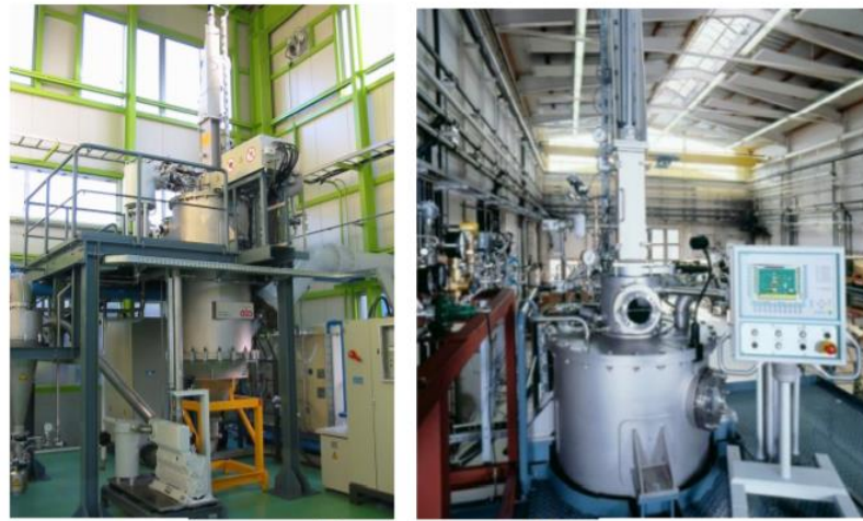
18 Сурет – EIGA 50 атомайзері: а) жалпы түрі; б) балқыту камерасы
